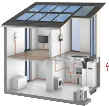
Für Photovoltaik-Dachanlagen bieten sich derzeit zwei Möglichkeiten an, den erzeugten Solarstrom zu verwerten: Der Strom kann entweder vollständig ins Netz eingespeist oder teilweise bzw. vollständig selbst genutzt werden. Die effizienteste Art der elektrischen Wärmeerzeugung ist die Wärmepumpe. Dabei werden aus einer Kilowattstunde Strom unter Nutzung kostenloser Umweltwärme bis zu vier Kilowattstunden Wärme gewonnen.
