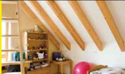
LINITHERM Aufsparren-Dämmung mit sichtbaren Sparren und putz-, streich- bzw. tapezierfähigem Zwischensparrenbereich
