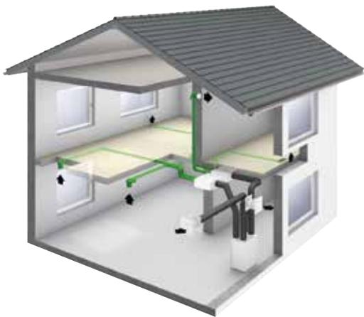
Schematische Darstellung einer kontrollierten Be- und Entlüftungsanlage
