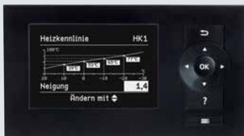
Vitotronic Regelung - einfache Bedienung durch menügeführte Benutzerführung und grafische Darstellung, wie zum Beispiel der Heizkennlinienanzeige.
